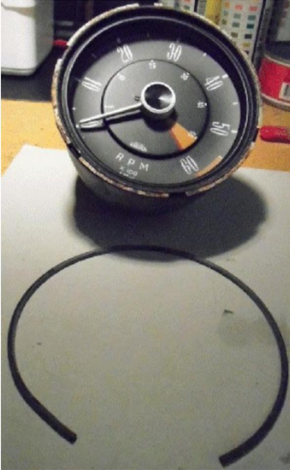
En fait, il ne s'agit pas vraiment d'un joint torique mais d'un tube en caoutchouc coupé à exactement la bonne longueur.
