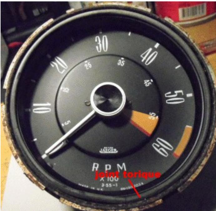
La vitre appuie sur son pourtour, sur un joint torique. C'est grâce à la compression de ce joint que
