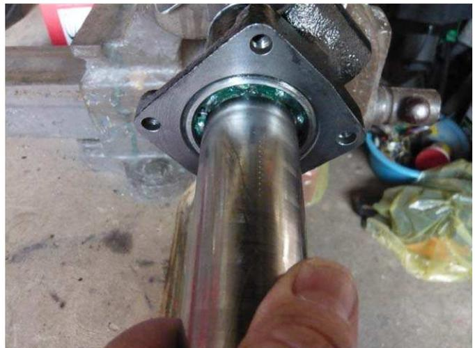
**5ème étape :** mise en place des carters en tôle, des joints et du plateau porte mâchoires.
