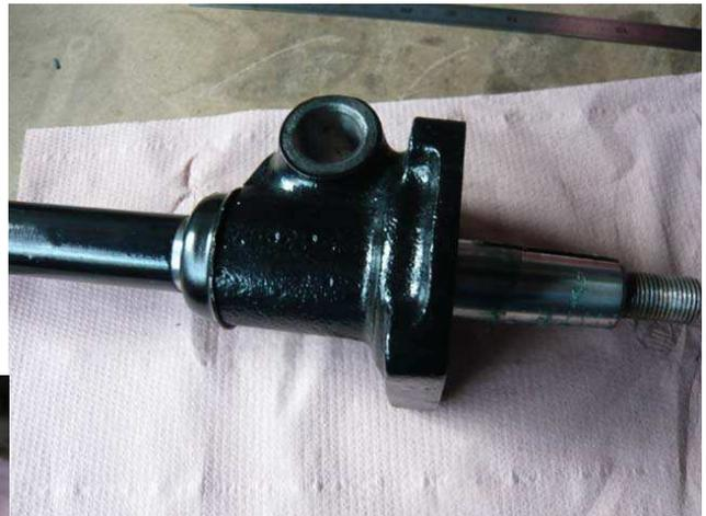
Graisser et positionner le roulement à billes
