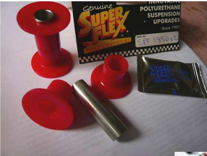
Comme indiqué à la page 2 j'ai utilisé un kit superflex, le tube est en inox et il n'y a plus ces coupelles de tôle avec un le petit joint. Les deux bagues rouges sont incurvées vers l'extérieur, une fois montées l'étanchéité est assurée.
