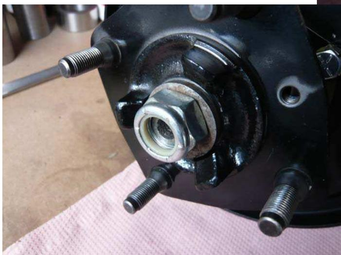
On met en place le moyeu en vérifiant la position de la clavette, puis la grosse rondelle plate et on approche l'écrou à la main.
