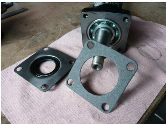
Mettre en place le joint à lèvres dans le carter en tôle, lèvres vers le roulement pour empêcher la graisse de sortir (huiler l'extérieur du joint avant).
