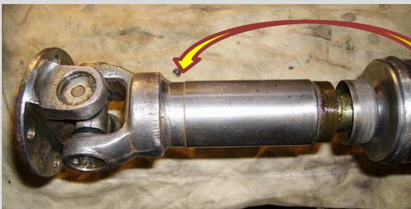
Vérification de la partie coulissante pour amortir les chocs au pont lors de démarrage ou de décélération. pas de jeu à ce niveau ce qui est rassurant.
