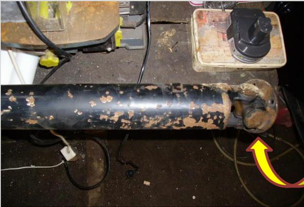
Vérification des cardans de l'autre côté, le premier constat donne un croisillon avec du jeu. Nous allons le remplacer
