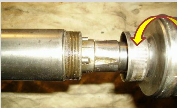
Nettoyage de la graisse et vérification des petits rouleaux si tous présent et dans le bon sens. mettre une nouvelle graisse et resserrer la partie coulissante avec la bague de serrage.
